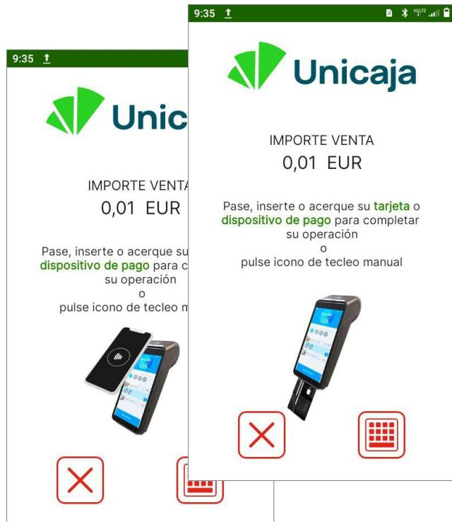
**2. Acerca la tarjeta o dispositivo contactless a la parte superior del tpv o insertar la tarjeta en la ranura frontal, como se muestra en el display o de ser una operación sin tarjeta, pulsar el icono rojo de teclado para escribir el PAN.**
