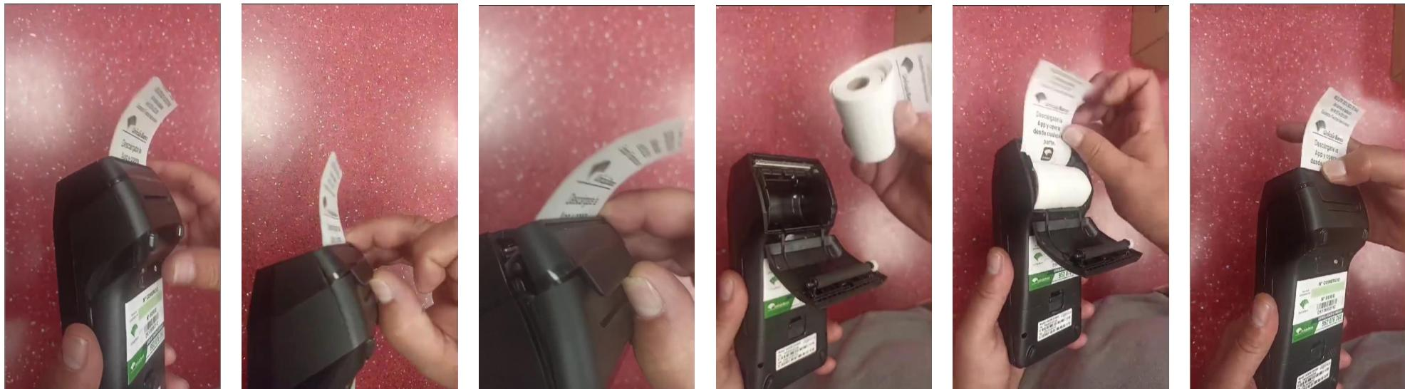
El cambio del rollo de papel térmico se hace por la parte inferior, así que, en primer lugar se gira el terminal y se tira de la pestaña de cierre de la tapa de impresora hasta escuchar un clip, que indica que está abierta. Se repone el rollo de papel térmico, con la cara imprimible(la blanca) hacia abajo y la cara impresa con información de la Entidad orientada hacia arriba, para que al cerrar la tapa de impresora, se vea como en la foto final.
